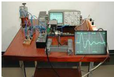
Oscillateur électrique connecté à un oscilloscope
