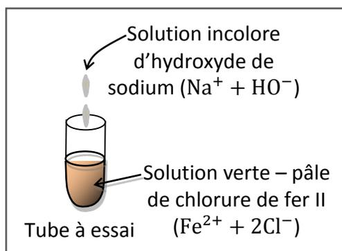
Observations : On observe la formation d'un précipité verdâtre d'hydroxyde de fer II  $Fe(OH)_2$ . Il provient de la réaction entre les ions fer II et les ions hydroxyde suivant l'équation – bilan :  $Fe^{2+} + 2HO^- \rightarrow Fe(OH)_2$ .
