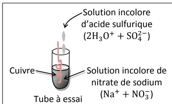
Observations : On un changement progressif de couleur (de l'incolore au bleu) de la solution et le dégagement d'un gaz incolore de monoxyde d'azote, qui au contact du dioxygène de l'air, se transforme en dioxyde d'azote.
