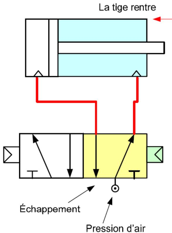
Schéma en position commande
