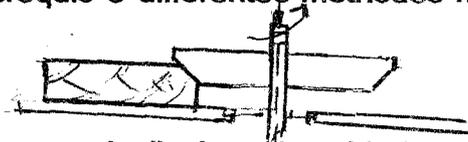
2) Exécution à la dégauchisseuse inclinaison du guide à un angle
