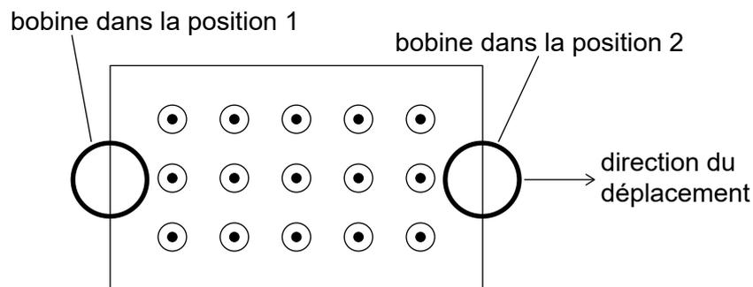
Quelle est le sens du courant conventionnel induit dans cette bobine pour les positions marquées ?
